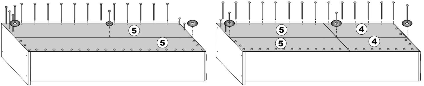
**5-** Colocar los cantos encolados en la unión de las TRASERAS, deslizando suavemente una plancha sobre los mismos, de manera que el calor active el adhesivo.
