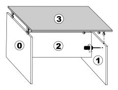
7- Ubicar la cajonera en la TAPA y ajustar cajas minifix. Ajustar la escuadra metálica a la TRAVIESA, con tornillo 4 X 14, verificando que el COSTADO DE CAJONERA quede paralelo al COSTADO DEL ESCRITORIO.
