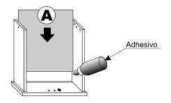
**d-** Colocar tarugos en la TRASERA DE CAJÓN, y unir con los dos LATERALES DE CAJÓN hasta que quede bien a escuadra.
