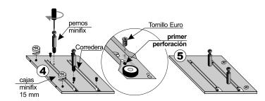
5- Colocar cajas minifix en el TRAVESAÑO. Luego unir éste a los COSTADOS, mediante unión minifix.
