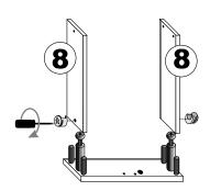
**c-** Deslizar el FONDO DE CAJÓN por los canales correspondientes de los COSTADOS. Se recomienda colocar adhesivo en los canales para lograr una unión uniforme)
