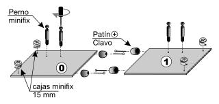
2- Colocar las cajas minifix y logotipo a presión. Unir las piezas mediante unión minifix.
